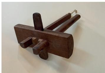
Utilizado para la marcación o medición precisa de elementos de carpintería en proceso de fabricación, el gramil o `roset` no ha caído en desuso y continúa siendo una herramienta que encuentra su hueco en las fases de diseño y como marcador.
