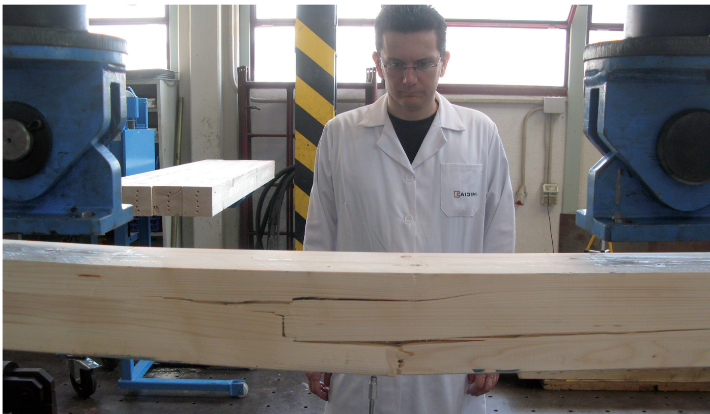
Ensayo destructivo de flexión, que tiene dos grandes inconvenientes: no puede realizarse en obra y la muestra ensayada queda inservible.
